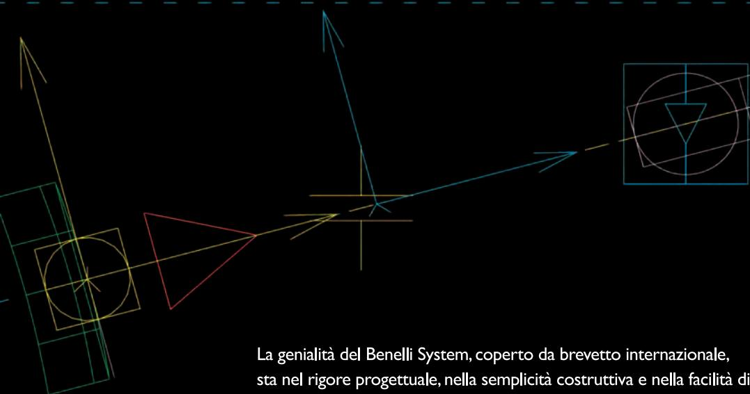
La genialità del Benelli System, coperto da brevetto internazionale, sta nel rigore progettuale, nella semplicità costruttiva e nella facilità di manutenzione. Tre sono le sue componenti principali: l'otturatore, che funge da massa inerziale e scorre liberamente su guide praticate sui fianchi della carcassa, la testa di chiusura e il mollone libero, alloggiato sull'otturatore. Ingegnoso ed efficace è il suo funzionamento.
